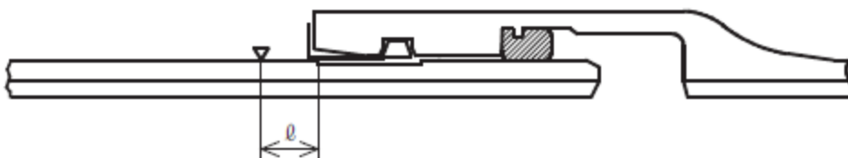
図-3. 2. 12 挿し口の挿入位置
