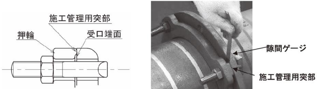
図-3. 2. 10 締め付け完了の状態
