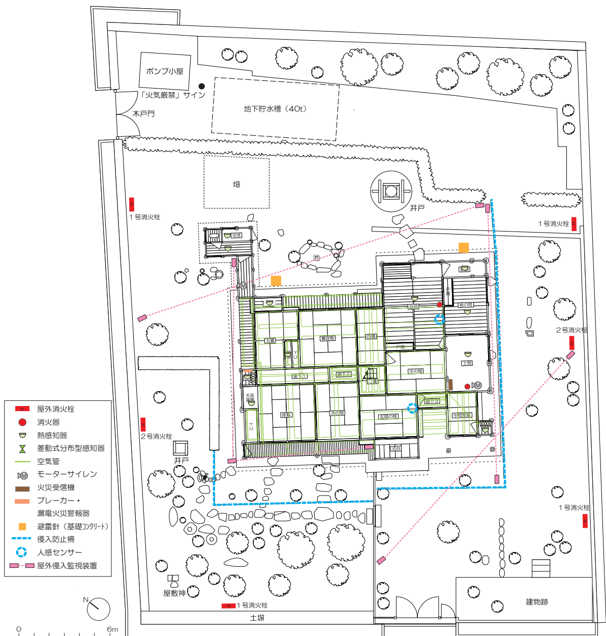
図 1-4-15 防災・防犯設備の配置状況
