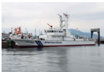
▲4基の放水銃を装備する消防機能型巡視艇「ことびき」は全長37m
