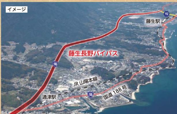
藤生長野バイパス（藤生町から長野まで）を整備することにより、現在の国道188号の慢性的な交通混雑の緩和や交通安全の確保をはじめ、台風時の越波や地震時の浸水、交通事故発生時の代替ルートの確保などの効果が期待される
