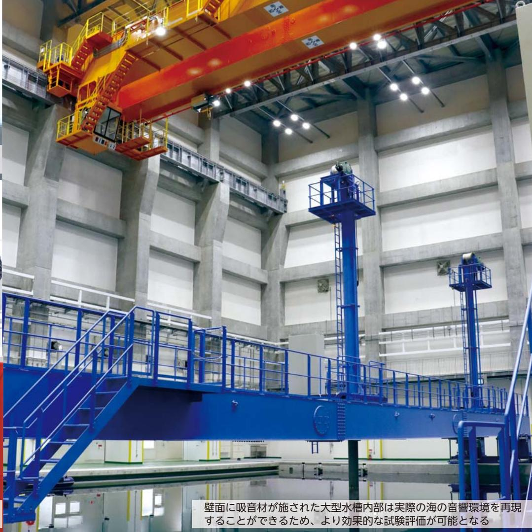
壁面に吸音材が施された大型水槽内部は実際の海の音響環境を再現することができるため、より効果的な試験評価が可能となる
