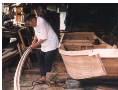
木材を曲げて使用することが多い造船では、木の性質を見極める技術も必要となる
