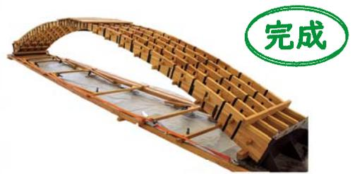
完成した模型は高さ1.3メートル、長さ8メートルで、錦帯橋の第3橋の5分の1の大きさ
