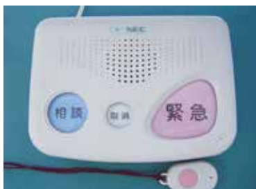
▲緊急通報装置
