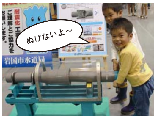
▲家庭に水を届ける「耐震管」は地震に強いと言われるが、本当に抜けないのかを引っ張って確認できる
